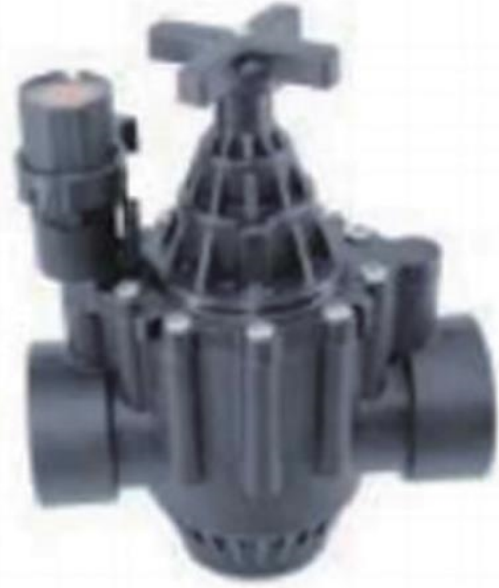
YH-CT119A 2-дюймовый электромагнитный клапан Давление: 0,10~1,04 МПа Скорость потока: 0,45~34,05 м3/ч температура воды: ≤50 °C Температура окружающей среды: ≤80 °C
