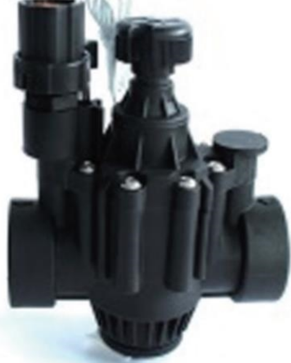
YH-CT119B 1,5-дюймовый электромагнитный клапан Давление: 0,10~1,04 МПа Скорость потока: 0,45~34,05 м3/ч температура воды: ≤50 °C Температура окружающей среды: ≤80 °C
