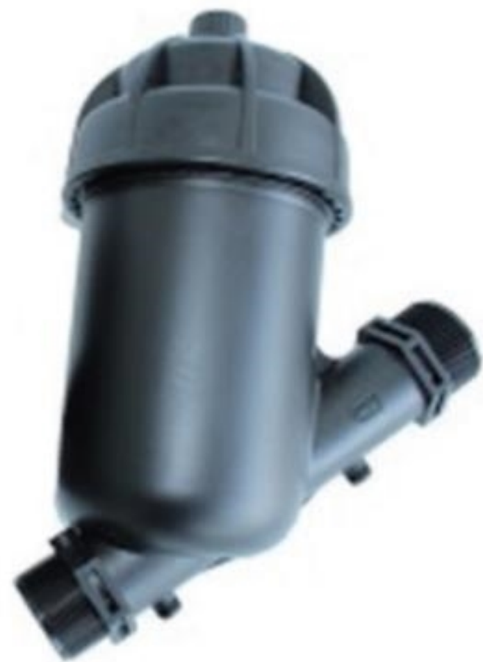
YH-CT121A 1-дюймовый встроенный фильтр Максимальное рабочее давление: 6 кг/см2 Расход: 333 л/мин или 20000 л/час.
