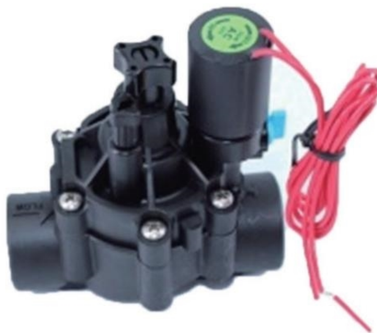
YH-CT118A 1-дюймовый электромагнитный клапан Давление: 0,10~1,04 МПа Скорость потока: 0,45~34,05 м3/ч температура воды: ≤43 °C Температура окружающей среды: ≤80 °C
