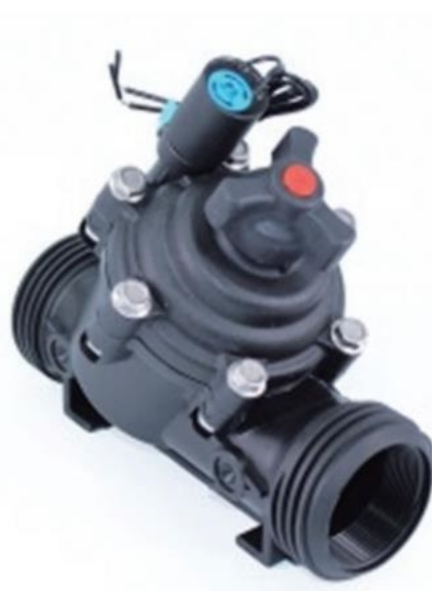
YH-CT120 2-дюймовый электромагнитный клапан Давление: 0,5-10 бар Скорость потока: 5~45 м3/ч температура воды: ≤42 °C Температура окружающей среды: ≤82 °C
