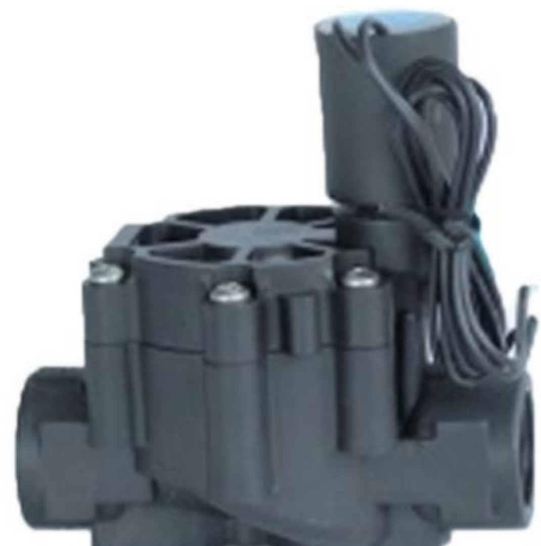
YH-CT118C 1-дюймовый электромагнитный клапан Давление: 0,103~1,034 МПа Скорость потока: 0,05~9,08 м3/ч температура воды: ≤50 °C Температура окружающей среды: ≤82 °C
